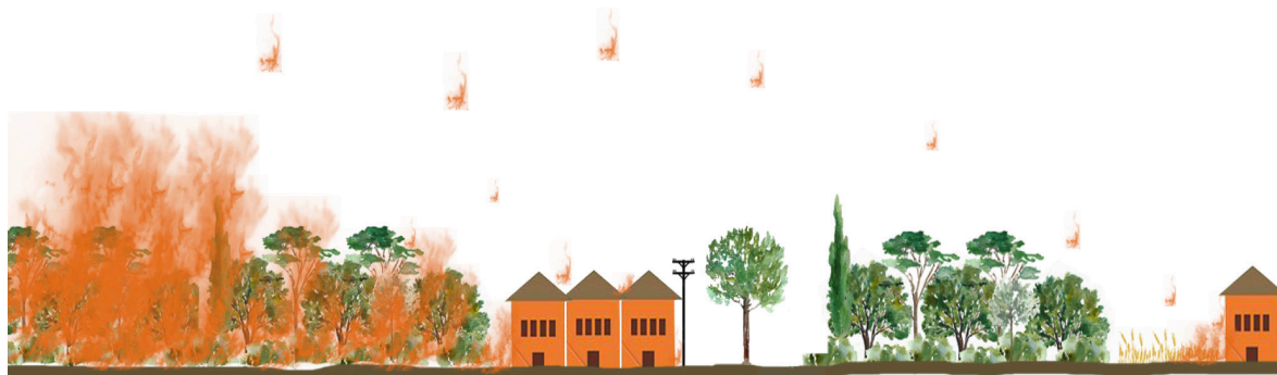
Ejemplo de afectación de un incendio forestal a una urbanización. Esta se ve directamente afectada tanto por el frente del incendio como por la lluvia de pavesas emitidas por el incendio cuando quema en alta intensidad el bosque circundante.
